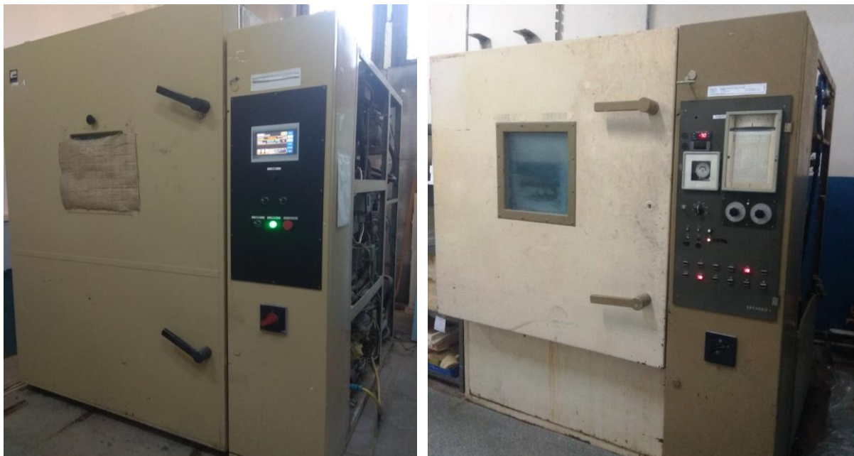
Рисунок 3 – Кліматичні камери для проведення циклічних кліматичних впливів
