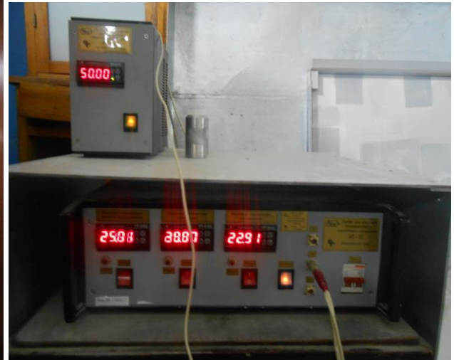
Рисунок 2 – Установка для визначення теплопровідності згідно з ДСТУ Б В.2.7-105-2000 (ГОСТ 7076-99)
